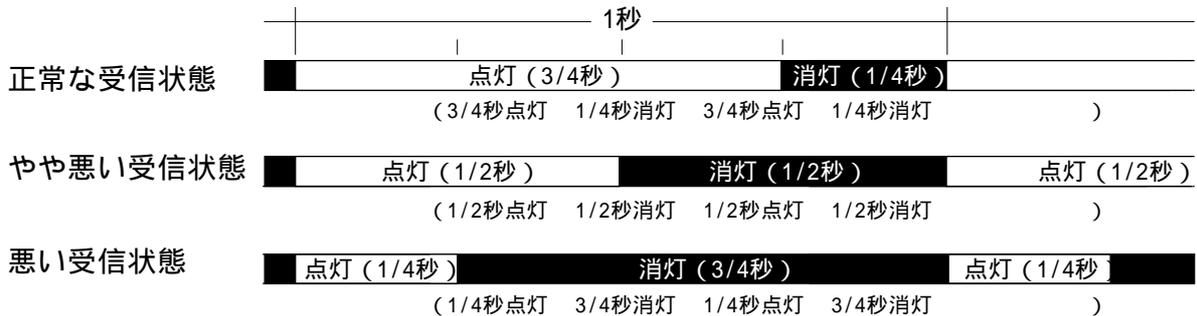
正常に受信し時刻補正ができていれば受信状態表示灯は翌日の受信時まで点灯しています。消灯の場合は正常に受信していませんので時刻補正はされていません。（右図参照）
