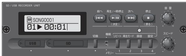
このたびは、SD/USBレコーダーユニットをお買い上げいただき、誠にありがとうございました。本機は、SDカード/USBメモリーに収録されたMP3/WMA形式の音源ファイルの再生、及び本機が接続された機器の音声をMP3形式で録音するためのレコーダーです。使用するメディアは、SD/SDHCカード(別売)、および、USBメモリー(別売)です。用途に適した容量のものを別途ご用意ください。
