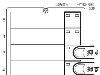
◆火災放送時に放送復旧スイッチを押した後、放送階選択スイッチを押すと、第2シグナル音が鳴ります。
