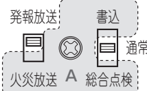
発報放送／火災放送 切換スイッチ 発報放送時 (Aの刻印が表)
