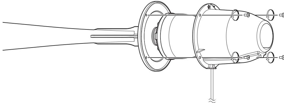
②接続端子のねじを緩め、Y端子の接続を変更し、入力W数を切り替えます。
