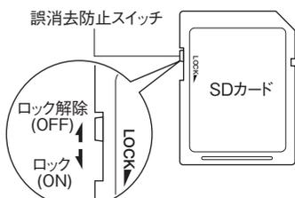
◇SDカードの横に付いている誤消去防止スイッチをロック側にしますと、録音、消去などカードの内容を変更することができません。再生時に誤操作によるデータの消失を未然に防ぐため、このスイッチをロック側にされることをお勧めします。
