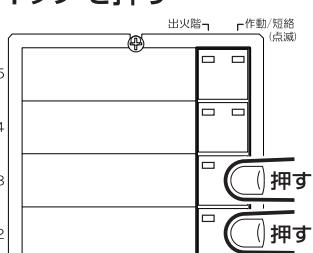
◆火災放送時に放送復旧スイッチを押した後、放送階選択スイッチを押すと、第2シグナル音が鳴ります。
