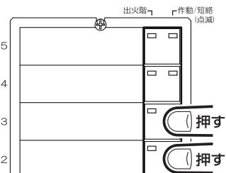
◆火災放送時に放送復旧スイッチを押した後、放送階選択スイッチを押すと、第2シグナル音が鳴ります。
