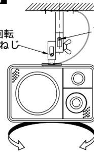
首振りロックねじ、または左右回転ロックねじをゆるめて、スピーカーの取付角度（水平方向）を調節する
