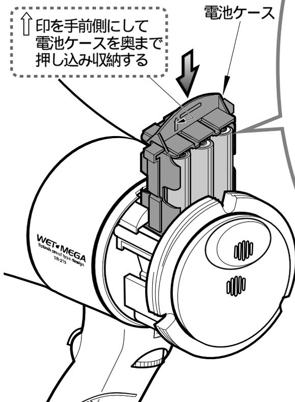
2-2 乾電池 (R6P/LR6) 6本を電池ケースに表示されている極性表示に合わせて入れる
