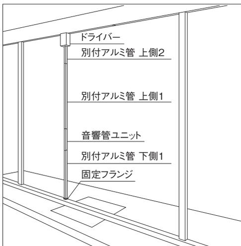
○音響管ユニットの中心は、お客様の口の高さにしてください。配置は、口の位置から左右いずれかの適した側に300mm~400mm離れた位置が最適です。
