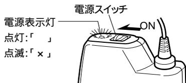
電源スイッチを入れ、電源表示灯が点灯すれば設定したグループ / チャンネルは正常です。
