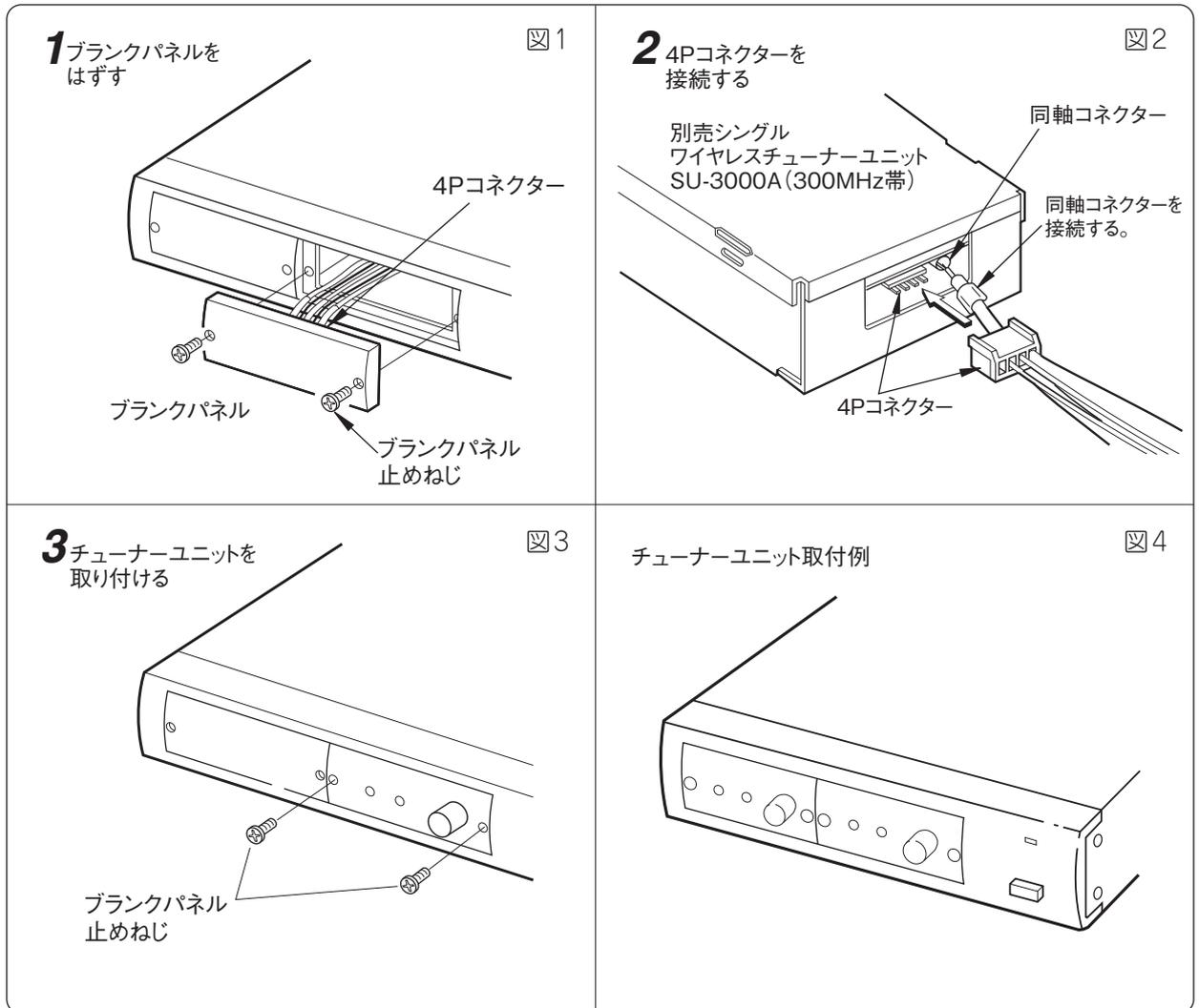
**1** 本機の電源プラグをコンセントから抜き、ブランクパネルをはずしてください。ブランクパネルの裏側に4Pコネクターと同軸コネクターが差し込まれていますので、それらをブランクパネルから取りはずしてください。(図1参照)
